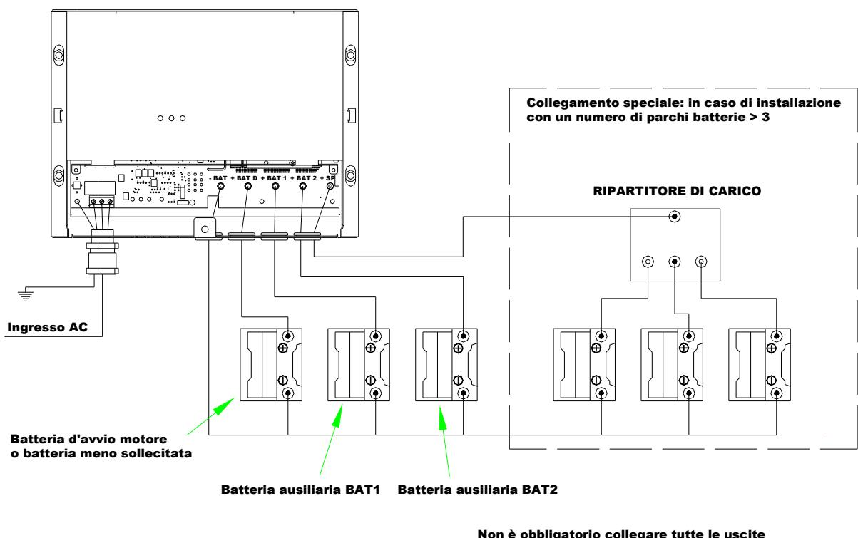
**Connessione batterie** (nel caso di configurazione sotto carica)
