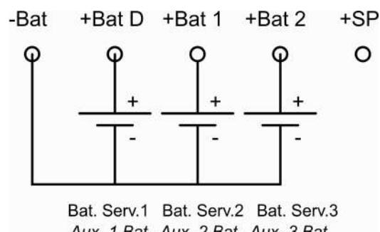
Montage 7: Montage config1 ou 2 ou 3 ou 4 ou 5 ou 6 + 1 Batterie service supplémentaire à travers un répartiteur (impératif)
