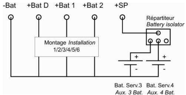
Montage 9: Montage config1 ou 2 ou 3 ou 4 ou 5 ou 6 + 3 Batteries Service supplémentaires à travers un répartiteur (impératif)
