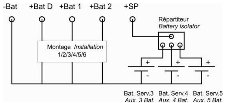
Montage 10: Montage config1 ou 2 ou 3 ou 4 ou 5 ou 6 + 3 Batteries Service supplémentaires à travers un répartiteur 2 entrées pour branchement d'une autre source de charge (ex : éolienne, panneau solaire, alternateur)
