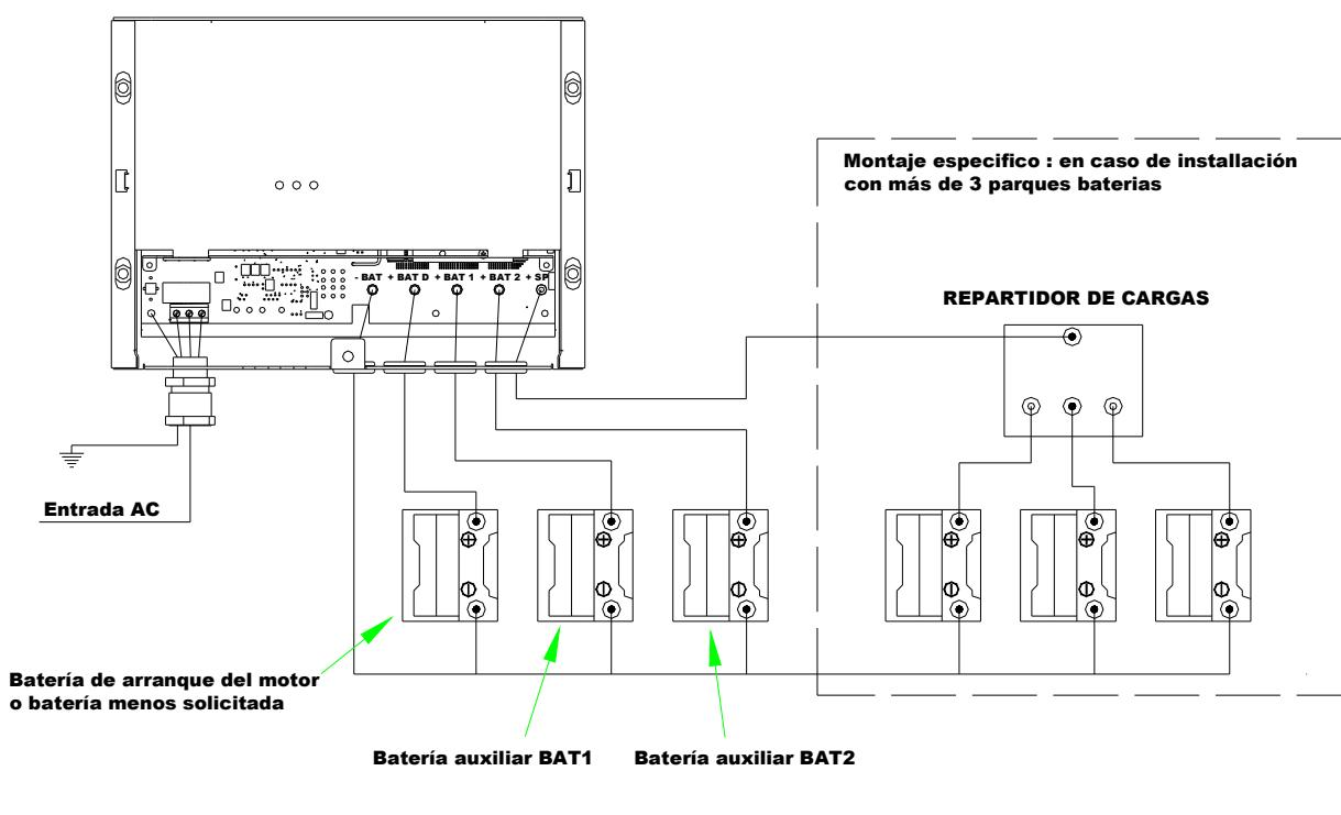
**Conexión baterías** (en caso de configuración cargador)
