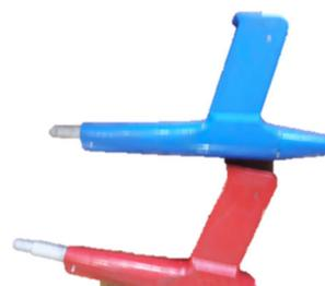
Pour garantir un bon contact électrique en fonction du composant à décharger, des pointes fines (PI) s'adaptent également sur le déchargeur.
