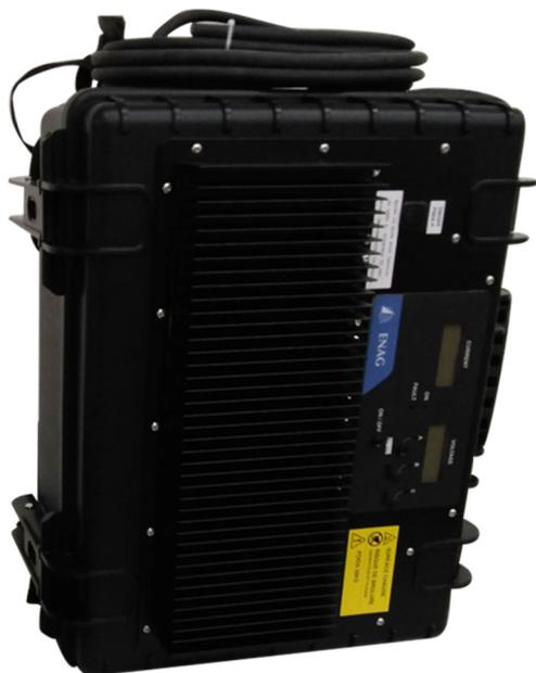
En stockage, le chargeur est raccordé au réseau électrique 230Vac, pour assurer la recharge de sa batterie interne.
